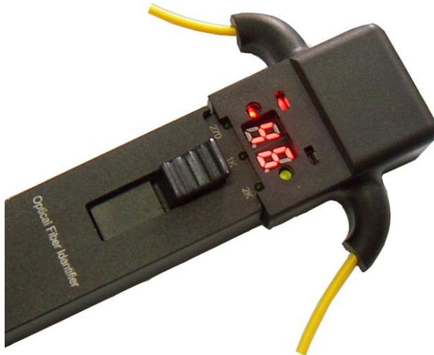
2. 需鬆開光纖時，稍微向前推動推鈕，接著按住推鈕的下後方，夾具會在彈簧的彈力作用下自動恢復，鬆開光纖。
