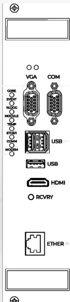
Ascentac OCAMS2049 系列之控制模組 (MCU) 具備一個系統內置的告警蜂鳴器及兩組外接告警介面，提供八組狀態燈號可隨時監測系統狀態。藉由 Ethernet 連線至監控伺服主機 (Test System Controller, TSC) ，可設定及查詢遠端光纖監測機 (RTU) 之 IP 、控制參數以及查詢與顯示遠端光纖監測機 (RTU) 測試狀態。當網路失聯或斷線，控制模組 (MCU) 仍可自動、自主依設定進行監測。
