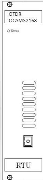
Ascentac OCAMS2168 之光時域反射器模組 (OTDR) 須搭配高通濾波器模組 (High Pass Filter, HPF)，高通濾波器模組 (HPF) 於在線監測架構可濾除原有之傳輸訊號波長，於離線光功率監測架構可濾除自發光源之波長，確保光時域反射器模組 (OTDR) 的使用壽命。
