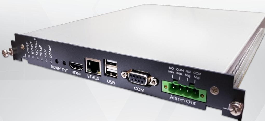
Ascentac OCAMS8041 系列之控制模組 (MCU) 具備兩組乾接點式外接告警介面，提供狀態燈號可隨時監測系統狀態。藉由 Ethernet 連線至監控伺服主機 (Test System Controller, TSC)，可設定及查詢遠端光纖監測機 (RTU) 之 IP、控制參數以及查詢與顯示遠端光纖監測機 (RTU) 測試狀態。當網路失聯或斷線，控制模組 (MCU) 仍可自動、自主依設定進行監測。
