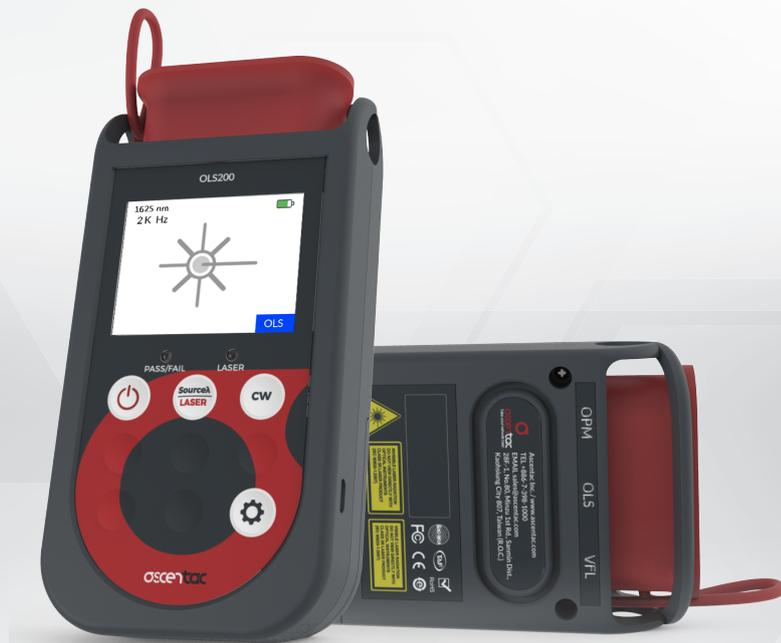
Ascentac OLS200 系列為光源，可穩定輸出光源。提供 850、1300、1310、1490、1550 及 1625nm 六種校正波長，用戶可選兩種，波長穩定性佳。此光源可以連續波、270Hz、1kHz 或 2kHz 之形式輸出。
