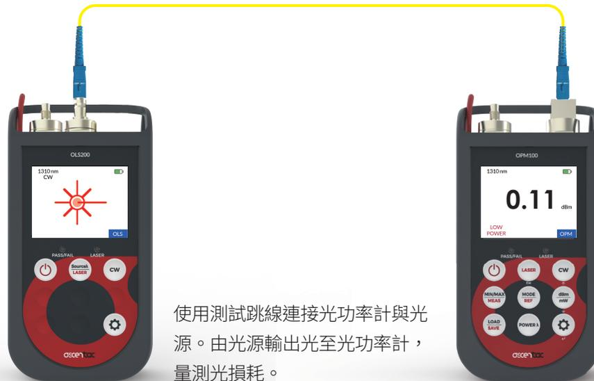
使用測試跳線連接光功率計與光源。由光源輸出光至光功率計，量測光損耗。
