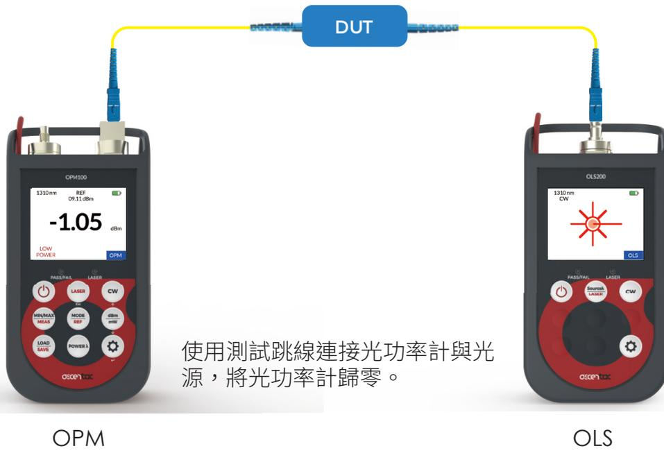
使用測試跳線連接光功率計與光源，將光功率計歸零。
