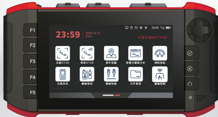
Ascentac OTDR 700C 系列為光時域反射器，利用光纖背向雷利散射技術進行光纖線路狀態的量測，以軌跡圖、事件表和事件地圖來具體呈現出分析結果，包含接頭反射事件、光纖微彎非反射事件、以及光纖斷裂，並準確地計算出光纖長度和損耗值。
