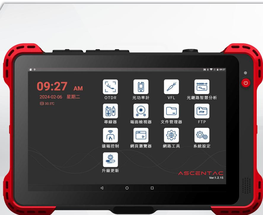
Ascentac OTDR710MAX 系列為光時域反射器，是一款用於檢測和紀錄光纖網路狀態的手持量測儀器，其高解析度搭配極短盲區確保光纖鏈路量測獲得準確的分析，保留耐用功能按鍵，且具備可觸控式螢幕。
