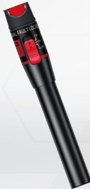
Ascentac VFL 210 系列為可見光源障礙定位器，可用於光纖障礙查測，診斷光纖線路問題，包括連接器接續不良、光纖斷裂和光纖微彎等現象，快速定位障礙位置，排除故障有效地解決問題；也可用於光纖識別，減少系統安裝時間。
