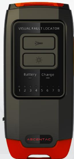
Ascentac VFL 220 系列為可見光源障礙定位器，可用於光纖障礙查測，診斷光纖線路問題，包括連接器接續不良、光纖斷裂和光纖微彎等現象，快速定位障礙位置，排除故障有效地解決問題；也可用於光纖識別，減少系統安裝時間。
